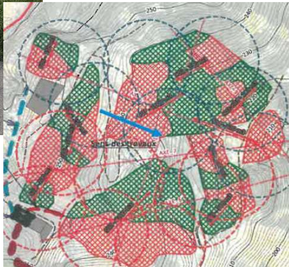
Couverture de la brumisation par zone de travaux aux Avinières
